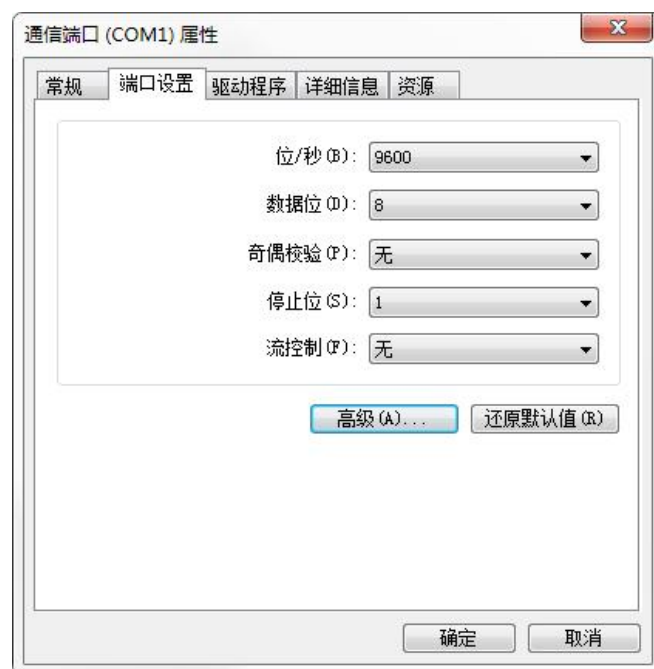
图 1.2.2 “超级终端”中的通信参数配置示意图
