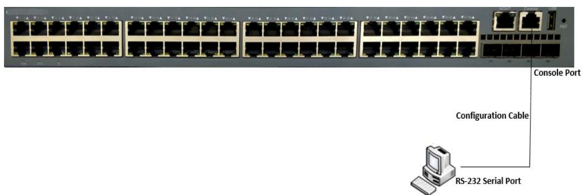
图 4-1 通过 Console 口搭建本地配置环境
