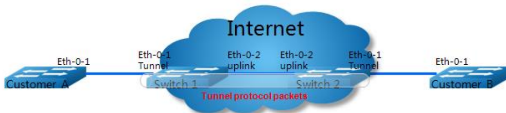
图 3-11 配置透传可配的二层协议报文拓扑图
