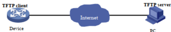
图 2-2 TFTP 组网应用示意图
